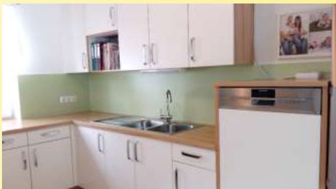
SGP – Sanierungs Großfliesen-Platten direkt über alte Fliesen geklebt in Privat- und Wirtschaftsküche mit Deckenpaneelle
